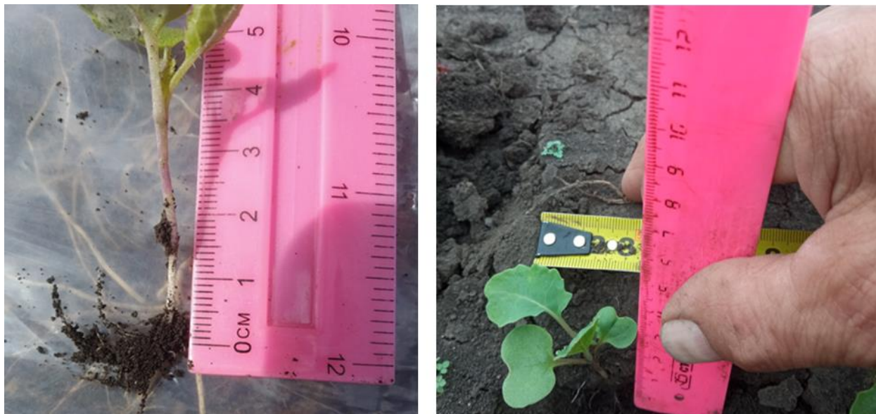
Рисунок 2 – Измерение глубины заделки семян ярового рапса, высеянных сошником №1
