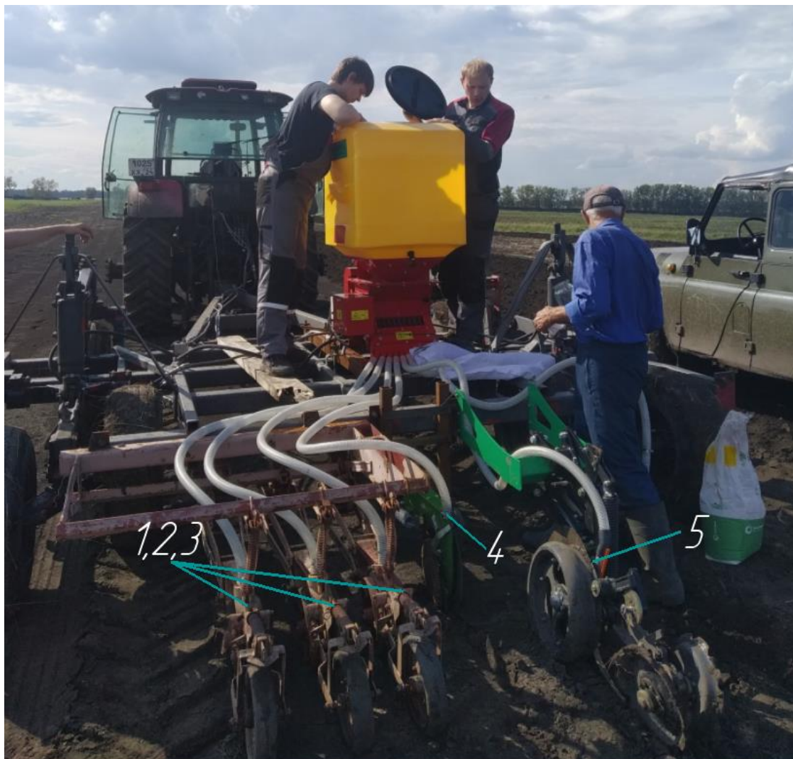
Рисунок 1 – Расположение дисковых сошников на экспериментальной сеялке
