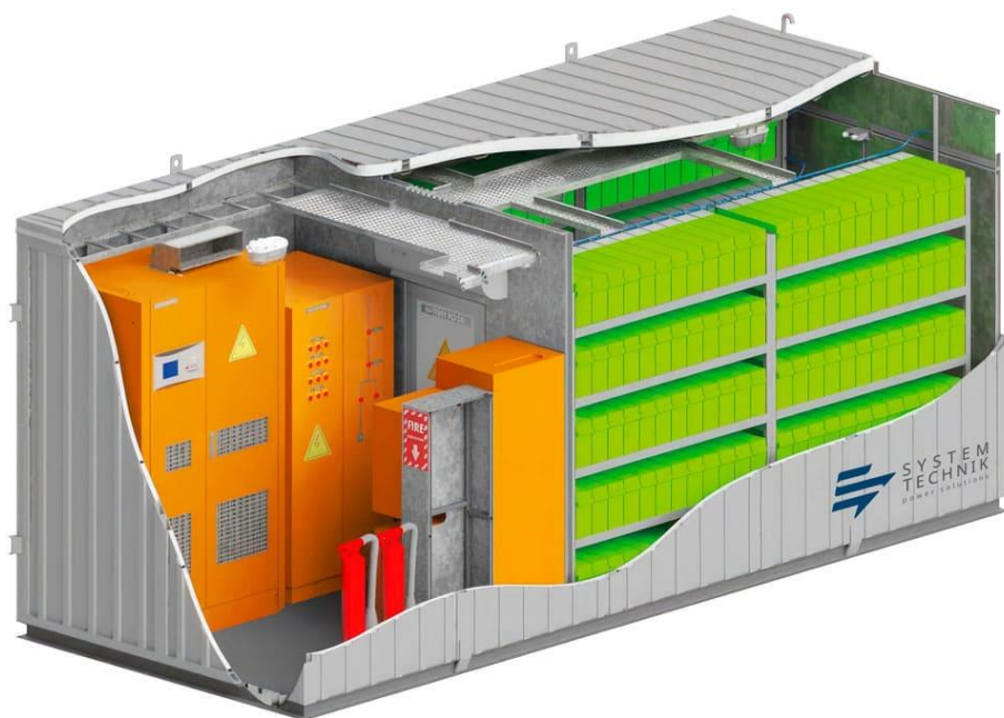
Рисунок 3 – Устройство системы хранения (с сайта https://energy-storage.ru/ )
