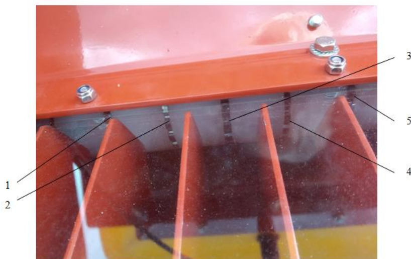
Рисунок 2 – Высевające катушки с разными ячейками
