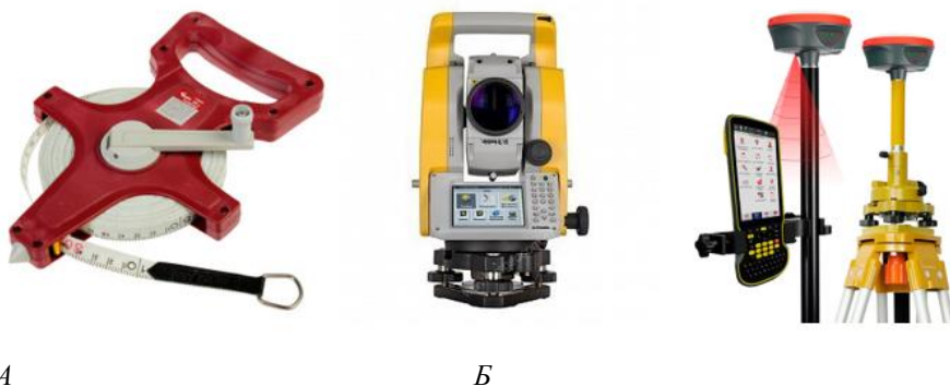
Рисунок 1 – GNSS-аппаратура: А – рулетки и линейки [с сайта https://tk-sp.ru/ruchnoj-instrument/izmeritelnyj-instrument/mernye-lenty/ ]; Б – Оптические и лазерные тахеометры [с сайта https://geodetika.ru/product/takheometr-trimble-m3-dr-ta-2-s-opticheskim-tsentrirom/ ]; В – GNSS-аппаратура [с сайта https://rosgeopribor.com/gnss-komplekt-alphageo-a10-kontroller-po/ ]
