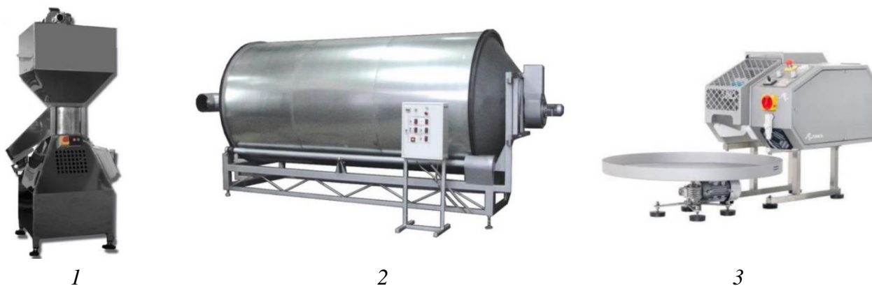
Рисунок 3 – Основные виды оборудования для переработки отходов хлебопекарной промышленности: 1 – измельчитель; 2 – сушильная установка; 3- экструдер пищевой
