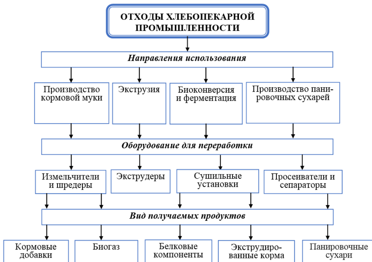
Рисунок 2 - Направления, процессы и продукты переработки отходов хлебопекарной промышленности
