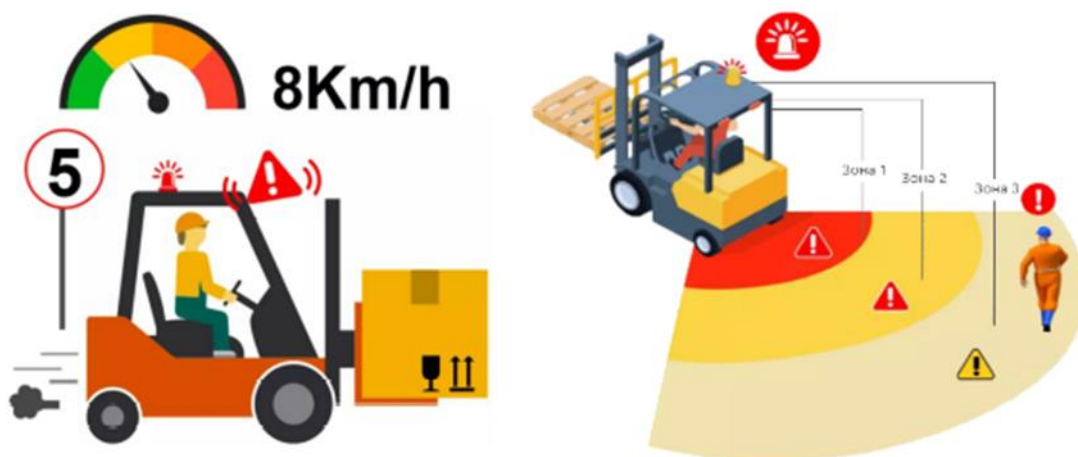
Рисунок 1 – Система безопасности и контроля зон вокруг вилочного погрузчика
