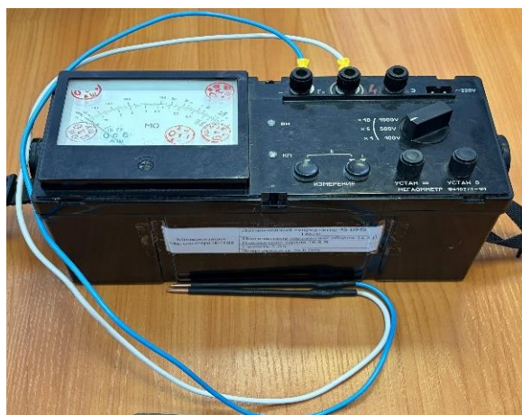
Рисунок 2 - Мегомметр Ф4102/1-1М с интегрированным литий-ионным аккумулятором
