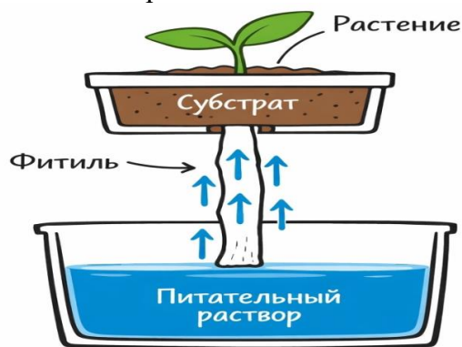
Рисунок 1 – Принцип работы фитильной системы [1]
