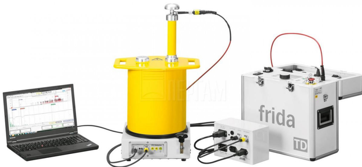
Рисунок 1 – PD-TaD 60 – система диагностики кабелей [с сайта https://www.pergam.ru/ ]
