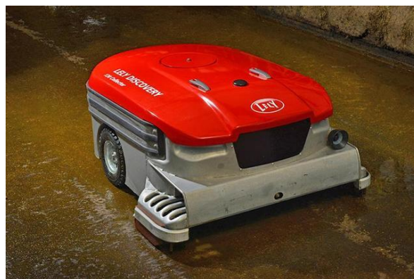
Рисунок 1 - Навозоуборочный робот. Lely Discovery 120 Collector [1]
