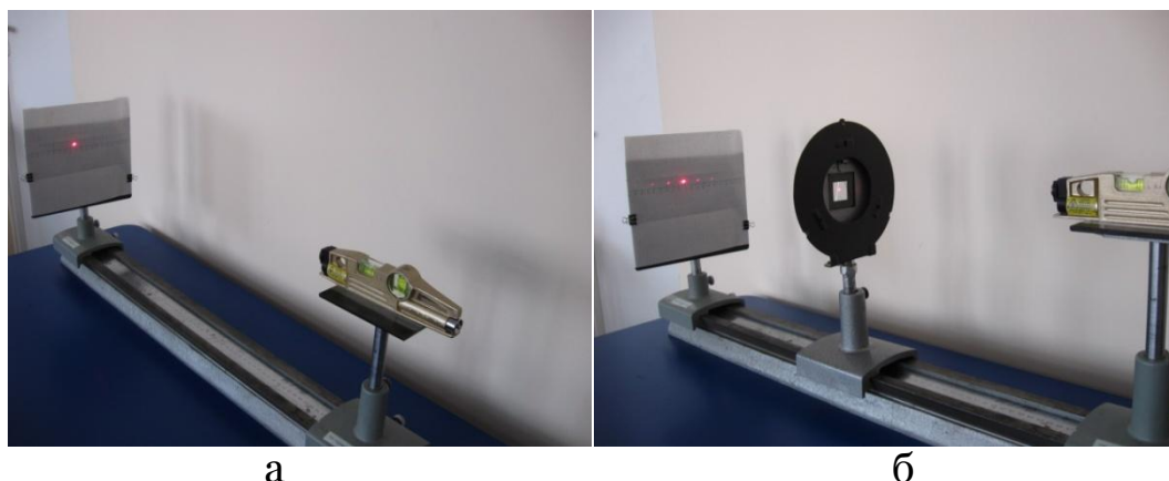
Рис. 1. Установка для наблюдения дифракции света
