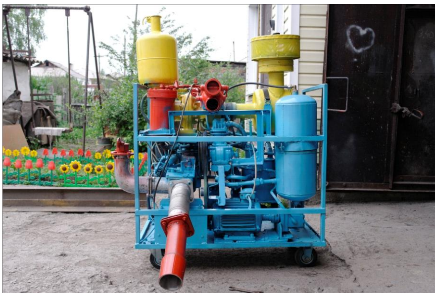
Рис. 2. Стенд для проведения экспериментальных исследований с гидроаккумулятором и тормозным устройством
