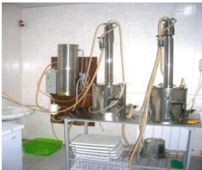
Рис. 2. Ультромагнитные экстракторы пантов
