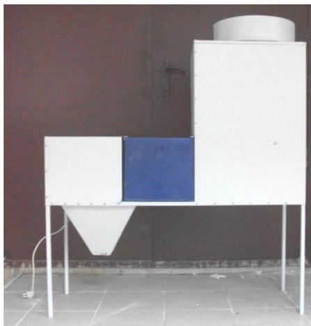
*Рис. 11. Установка для термической обработки сыпучих диэлектрических материалов [11]*
