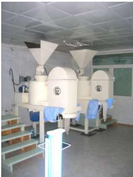
*Рис. 1. Ультразвуковые экстракторы пантов*
