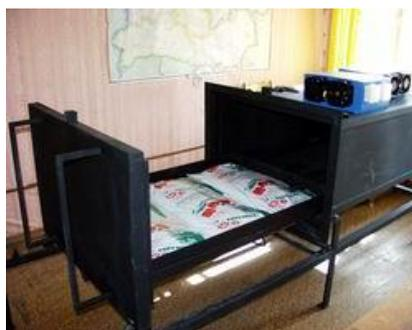
*Рис. 10. Оборудование для микроволновой стерилизации [10]*
