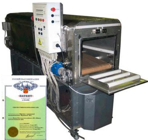
Рис. 5. Микроволновая установка туннельного типа серии «Арабис» [8]
