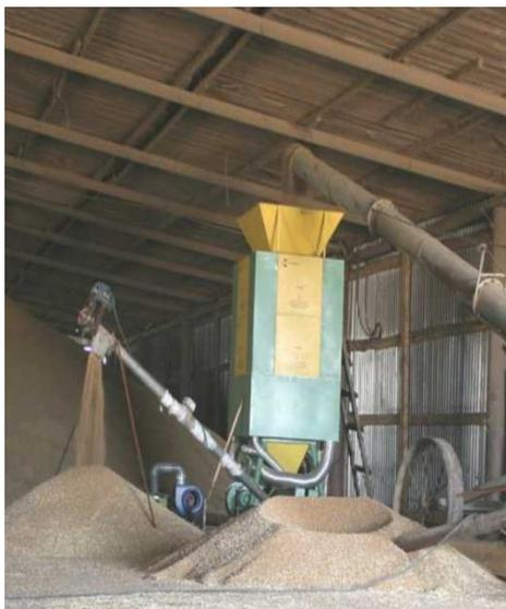
*Рис. 1. Установка микроволновая для сушки зерновых и масличных культур модели АСТ-3 [5]*
