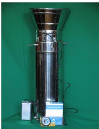
Рис. 3. Установка для предпосевной стимулирующей обработки семян "ЦИКЛОН-7"[3]
