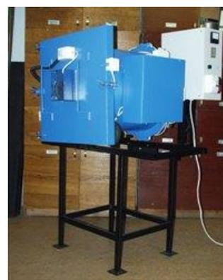
*Рис. 9. Установка для микроволновой сушки и стерилизации продуктов [10]*
