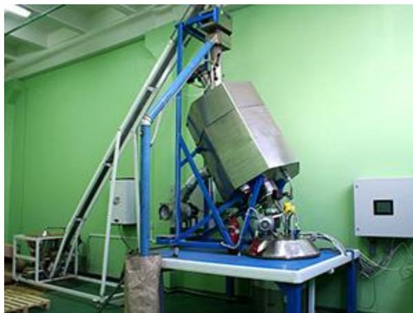
*Рис. 12. Установка микроволновой термической обработки «Поток» [12]*
