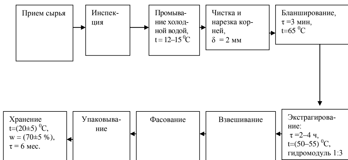
Рис. 5. Технологическая схема производства экстрактов из дикорастущего сырья
