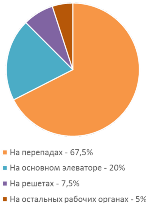
Рис. 2. Доля перепадов и сепарирующих рабочих органов в нанесении повреждений клубней картофеля (%) от общего количества повреждений по массе
