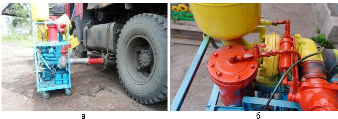
Рис. 1. Стенд для исследования ТКР: а – стенд в работе; б – гидроаккумулятор и тормозное устройство
