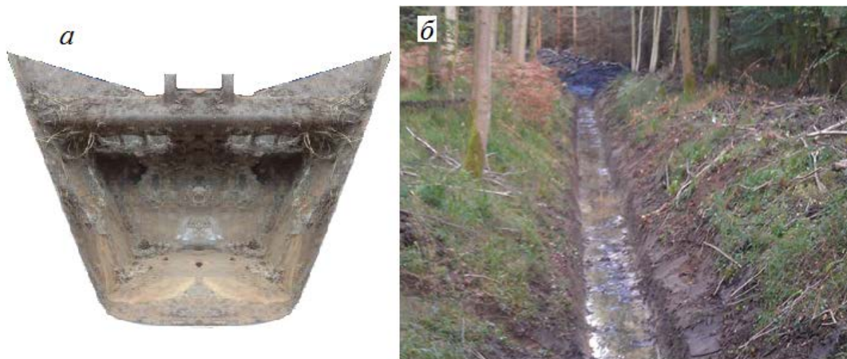
Рис. 4. Ковш специального профиля (а) и фрагмент канала, проложенного с его помощью (б)
