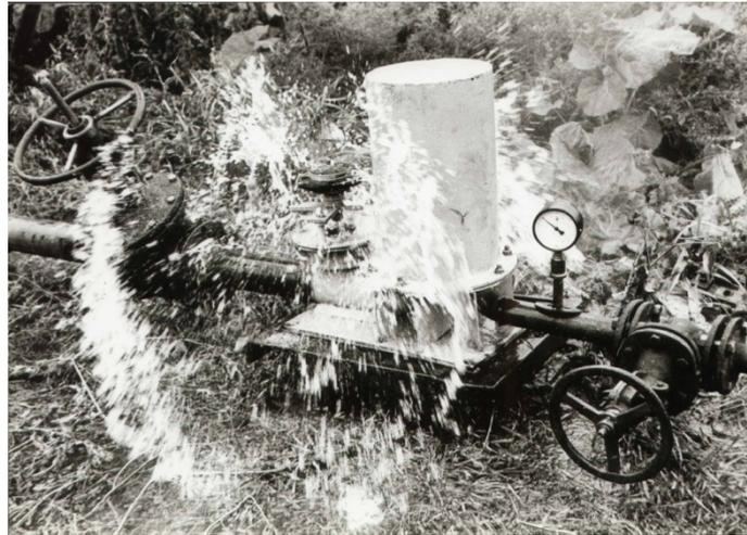
Рис. 5. Вид работы изготовленного гидротарана
