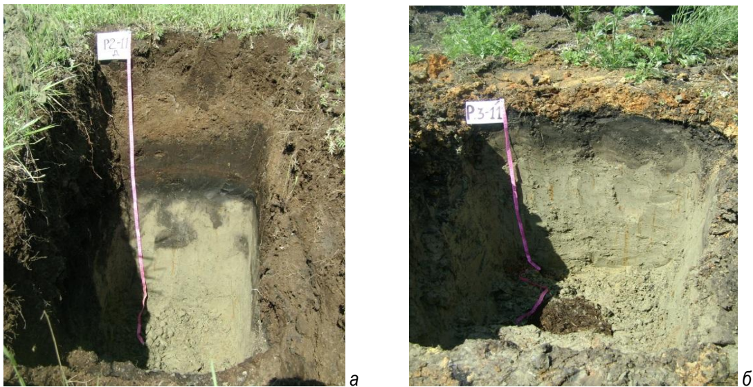
Рис. 1. Профили почвы, не нарушенной пожаром, и пирогенного образования: а – осушенная низинная торфяная маломощная почва; б – пирогенное образование (пожар произошел год назад)
