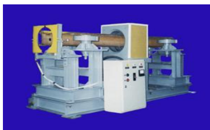
Рис. 1. Установка УРР для размагничивания рельсов в рельсосварочном производстве
