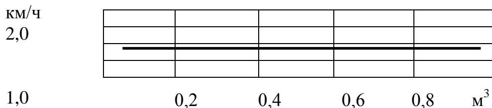
Рис. 3. График зависимости технологической скорости производства хлыстов от объема для комплекса машин: валочно-пакетирующая машина ЛП 19А; гусеничный трактор с пачковым захватом Лт 154А; сучкорезная машина ЛП-33А; челюстной лесопогрузчик ЛТ-65Б
