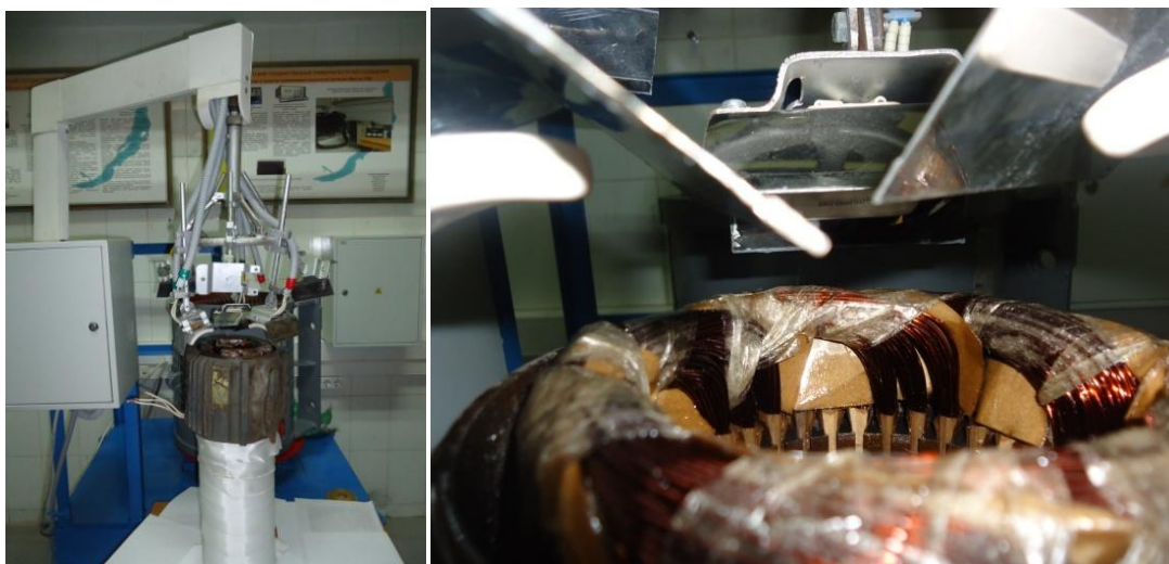
Рис. 2. Конструктивная схема установки для капсулирования изоляции
