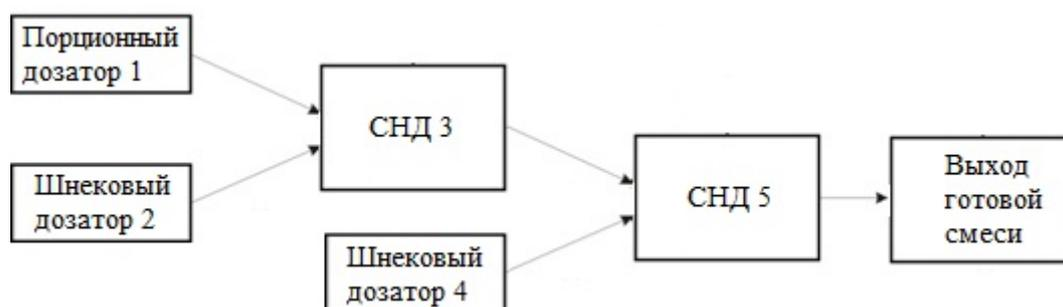
Рис. 1. Схема смесительного агрегата центробежного типа
