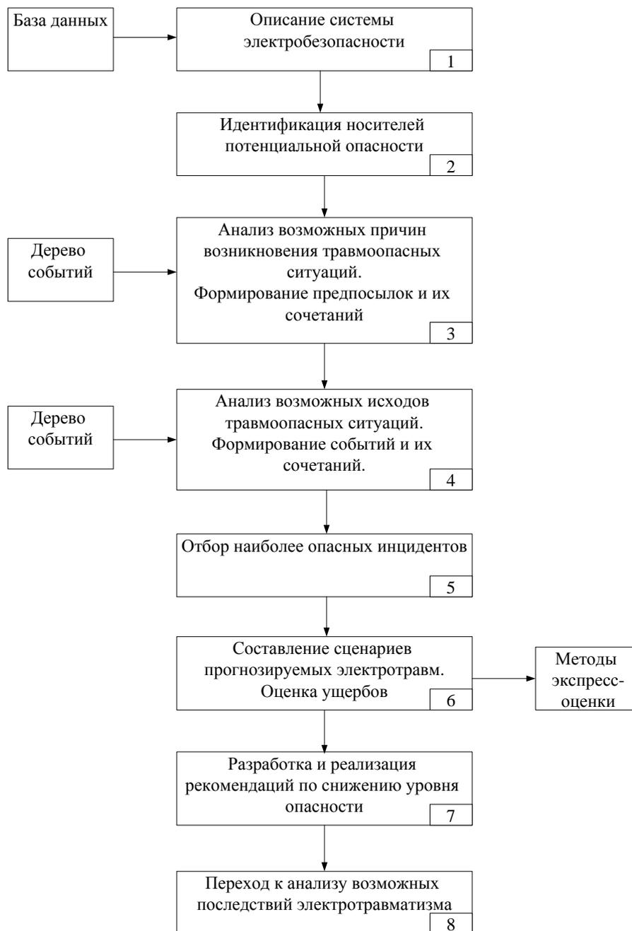
Рис. 1. Блок-схема построения диаграмм типа «дерево»
