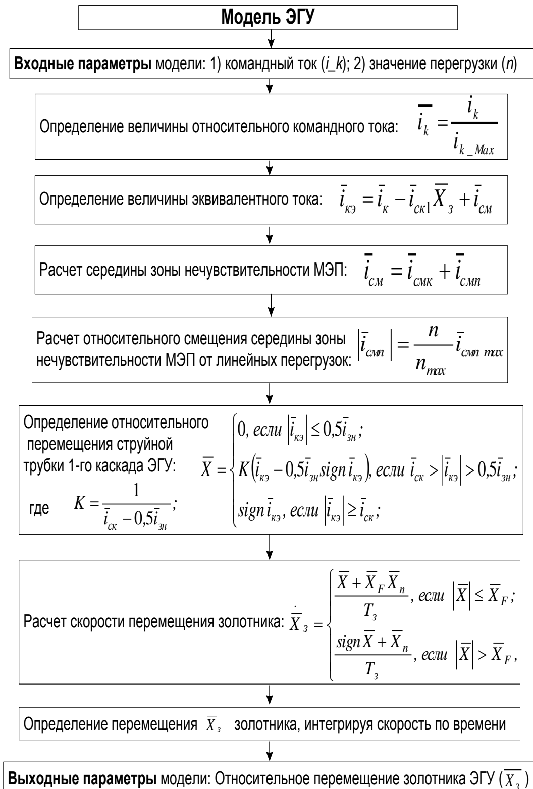
Рис. 3. Математическая модель работы ЭГУ с БФТУ
