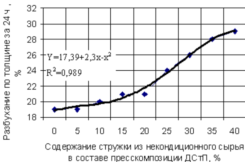
Рис. 1. Зависимость физических характеристик древесностружечных плит от содержания некондиционного сырья в составе пресскомпозиции
