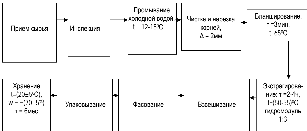
Рис. 5. Технологическая схема производства экстрактов из дикорастущего сырья
