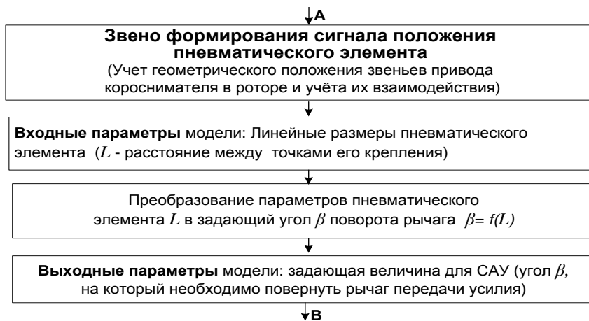
Рис. 5. Алгоритм расчетов звена формирования положения пневматического элемента
