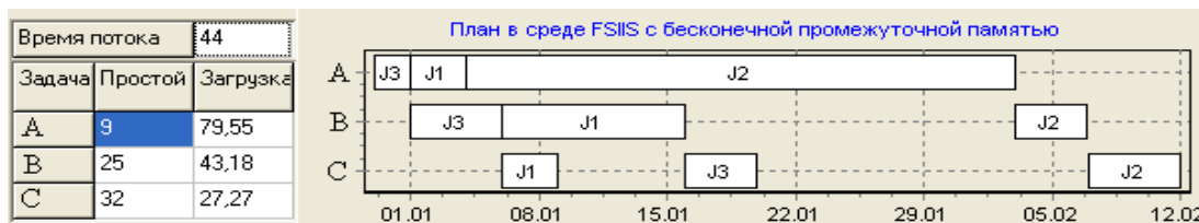
Рис. 4. Трехмашинный конвейерный FSIS-план с бесконечной промежуточной памятью
