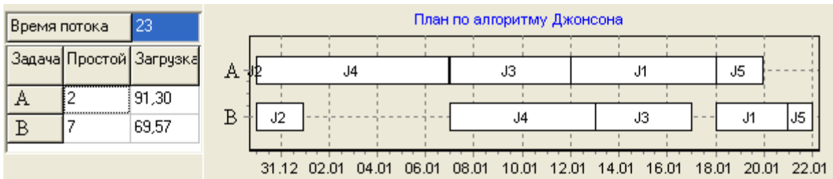
Рис. 2. Двухмашинный конвейерный план с минимальным временем потока
