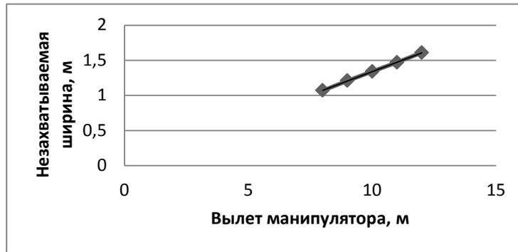
Рис. 6. Зависимость ширины необрабатываемой зоны (х) от длины манипулятора
