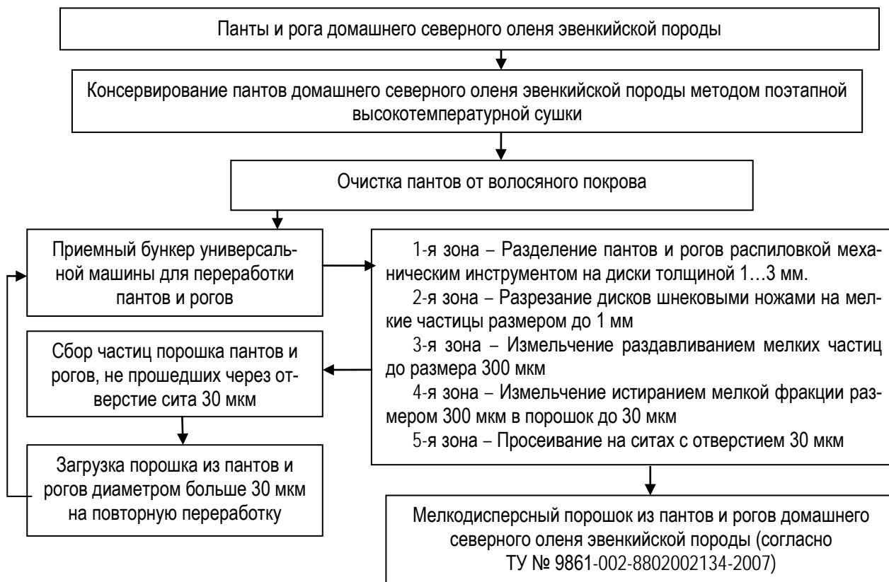
Рис. 1. Принципиальная схема процесса переработки пантов и рогов домашнего северного оленя эвенкийской породы
