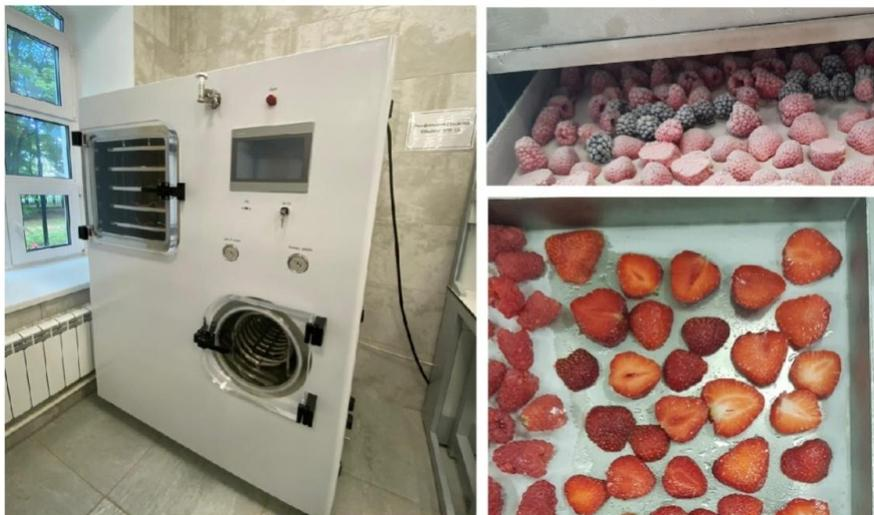
Рис. 2. Сублимационная сушилка и образцы клубники в процессе замораживания и укладки в камеру
