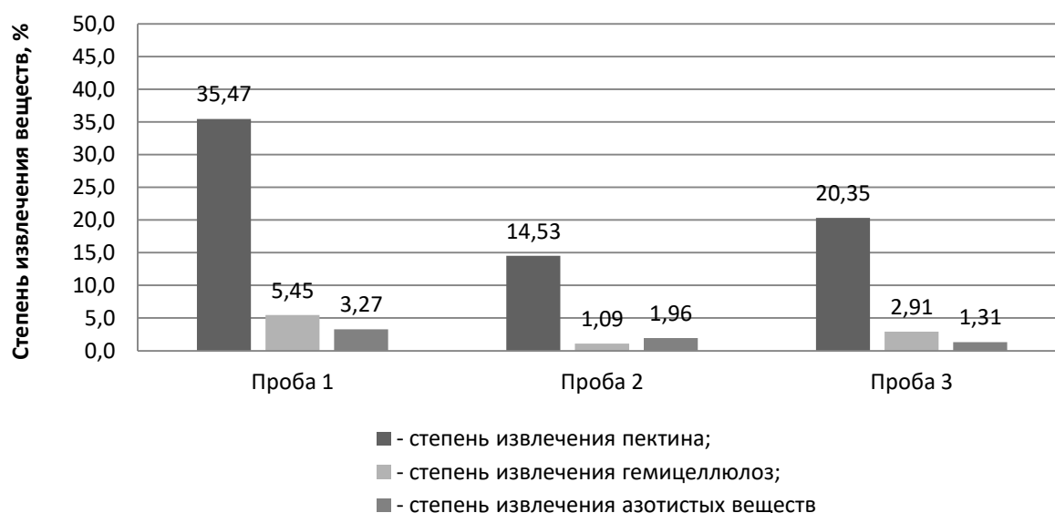
Рис. 4. Степень извлечения пектина, гемицеллюлоз и азотистых веществ в зависимости от используемого реагента The degree of extraction of pectin, hemicelluloses and nitrogenous substances depending on the reagent used
