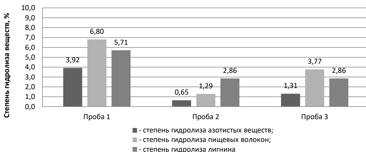
Рис. 1. Степень гидролиза азотистых веществ, пищевых волокон и лигнина в зависимости от используемого реагента The degree of hydrolysis of nitrogenous substances, dietary fiber and lignin depending on the reagent used
