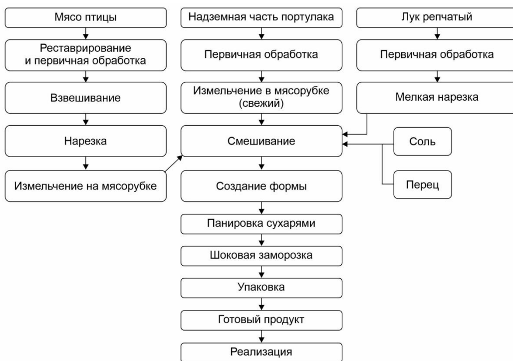
Рис. 2. Принципиальная схема получения мясных рубленых полуфабрикатов (котлет) с добавлением надземной части портулака огородного
