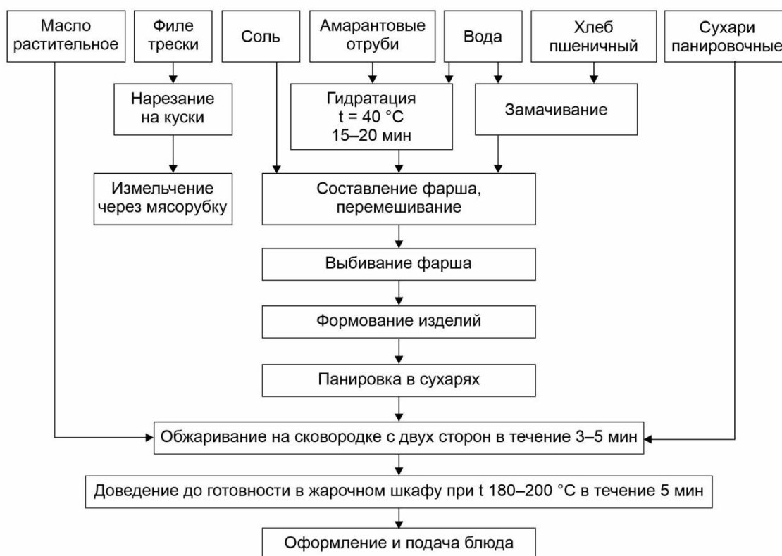
Рис. 1. Технологическая схема приготовления рыбных котлет с амарантовыми отрубями
