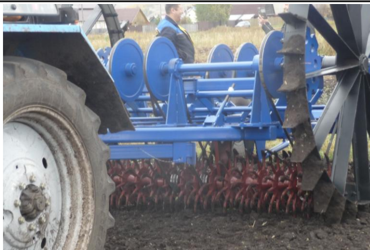
Рис. 3. Усовершенствованная система привода рабочего органа промышленного агрегата для вертикально-штыревой обработки почвы
