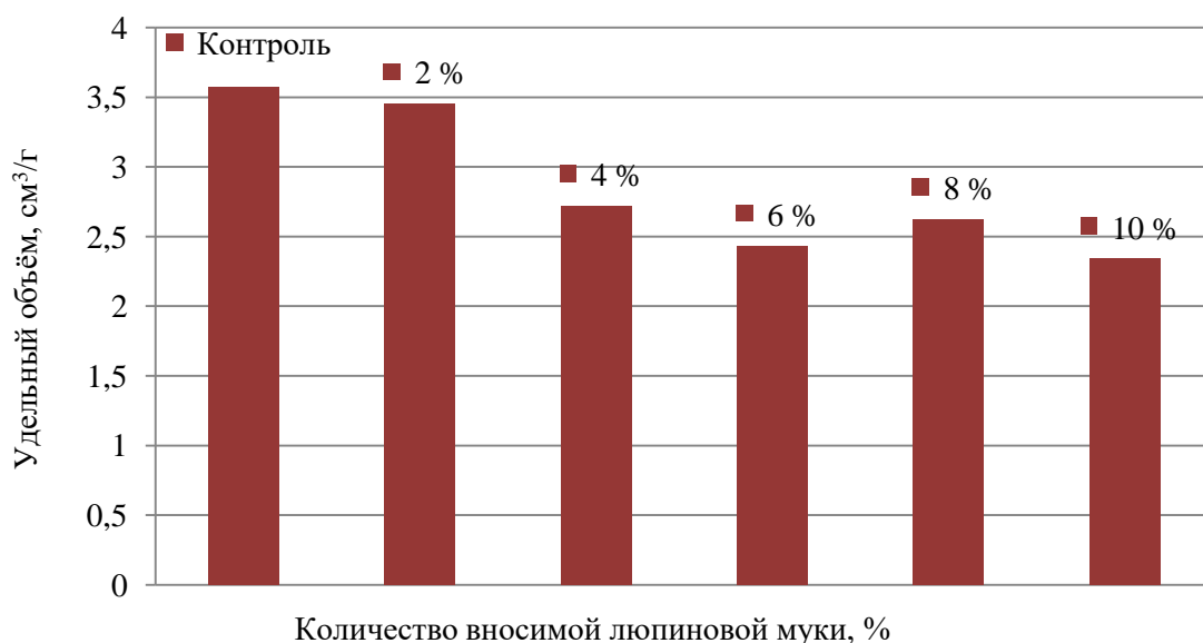
Рис. 4. Влияние добавления люпиновой муки в количестве 2–10 % на удельный объем хлеба
