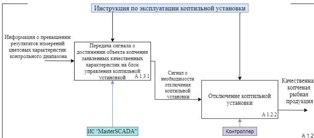
Рис. 3. Модель управления технологическим процессом копчения рыбной продукции
