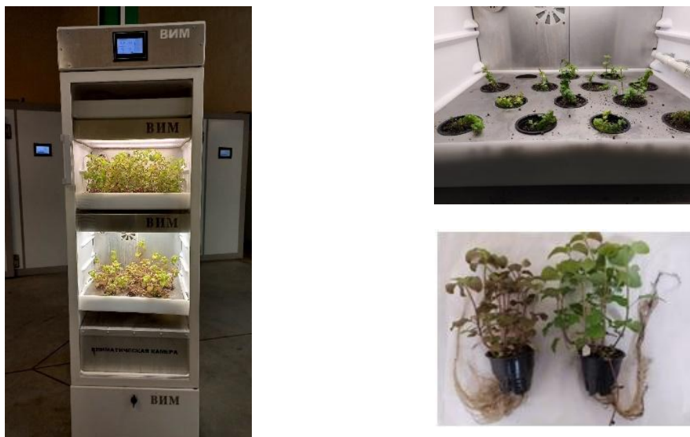
Рис. 3. Адаптация растений мяты водной в климатической камере ВИМ
