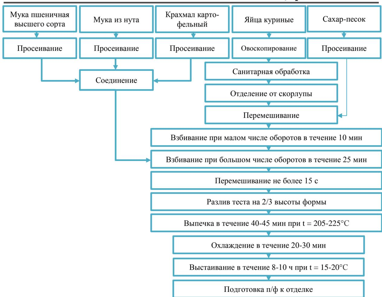
Рис. 1. Технологическая схема производства бисквитных полуфабрикатов
