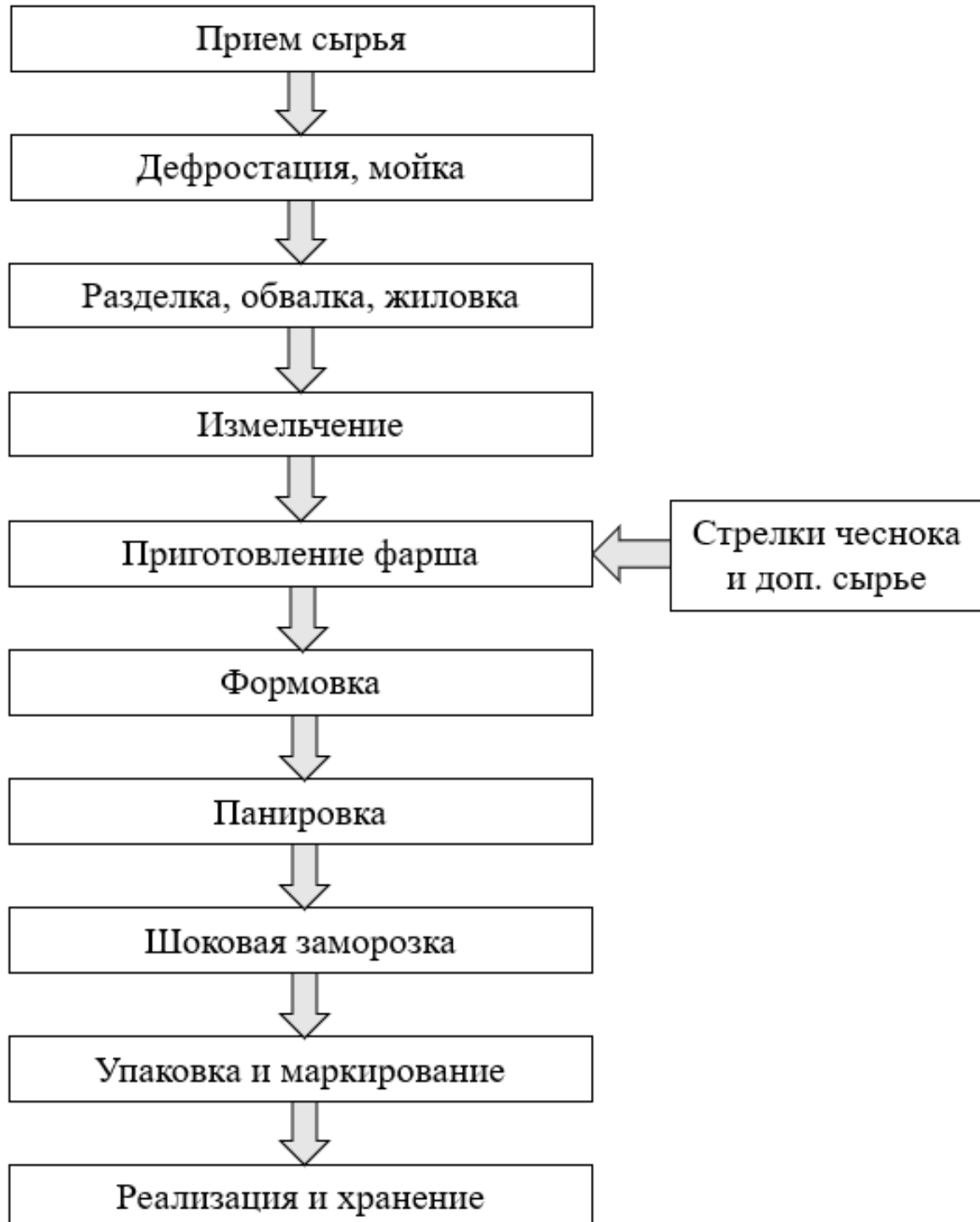
Рис. 1. Принципиальная технологическая схема получения опытного образца мясного рубленого полуфабриката
