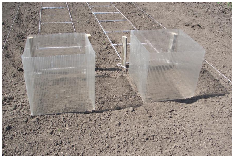
Рис. 1. Сосуды без дна из поликарбоната для вегетационно-полевого опыта
