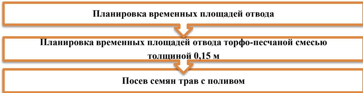
Рис. 4. Рекультивация земель по трассам подъездных автодорог
