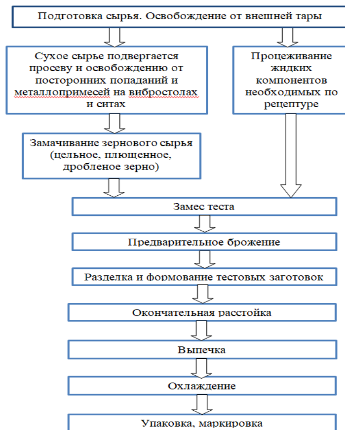
Рис. 3. Технологическая схема производства хлеба с использованием цельнозернового сырья
