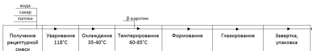
Рис. 1. Схема приготовления модельных образцов помадных конфет с бета-каротином
