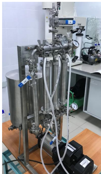
Рис. 3. Ультрафильтрационная установка МФУ-Р-45-300
