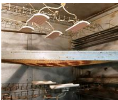
Рис. 3. Расположение керамических нагревателей в сушильном шкафу
