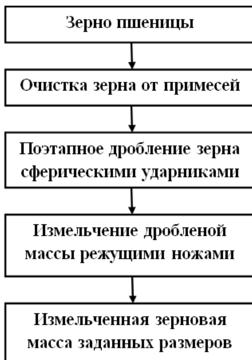
Рис. 4. Модернизированная технологическая схема дробления зерна пшеницы
