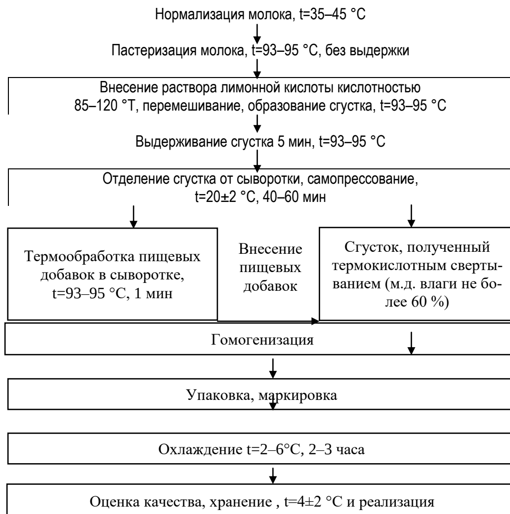
Схема технологического процесса производства творожного сыра с пищевкусовыми добавками
