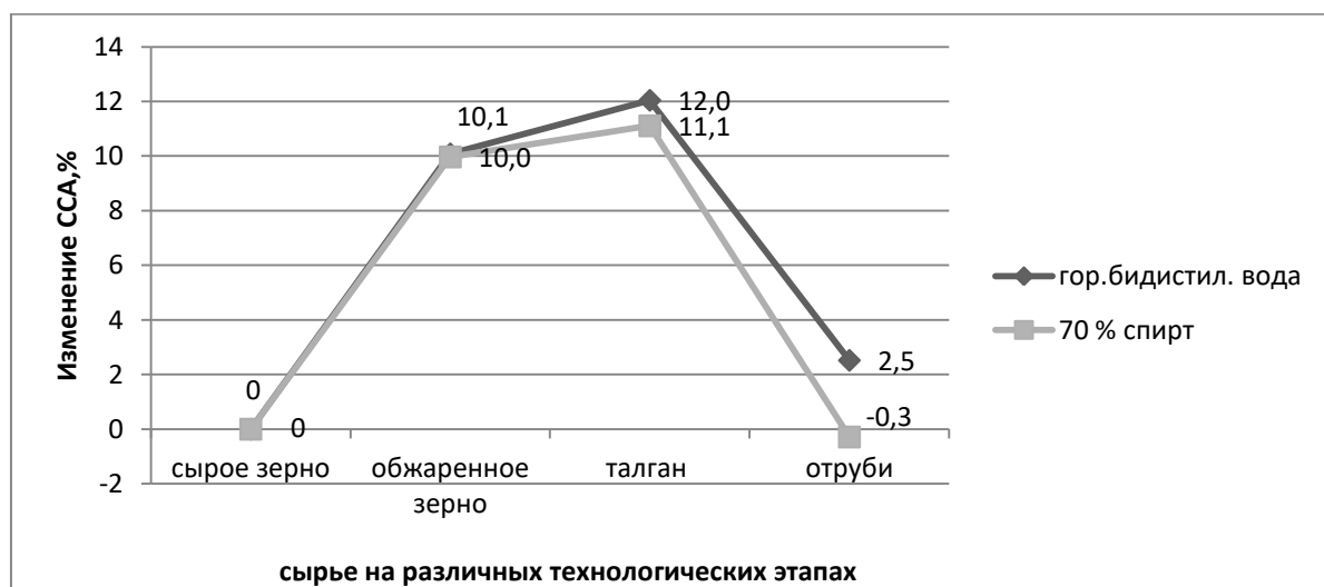
Рис. 2. Изменение суммарного содержания антиоксидантов в зерне ячменя на различных этапах технологического цикла производства талгана
