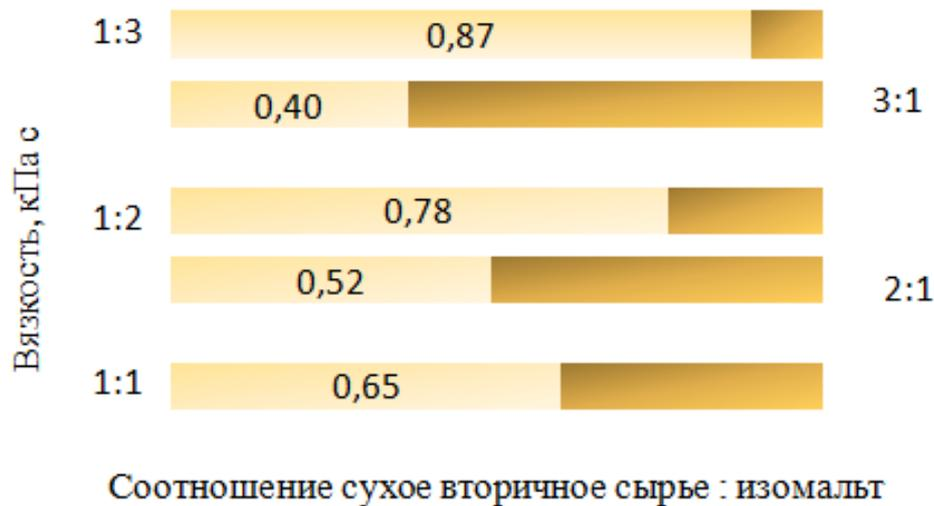
Рис. 1. Изменение вязкости карамельной массы при температуре 140 °С при различных соотношениях сухого обезжиренного молока и изомальта
