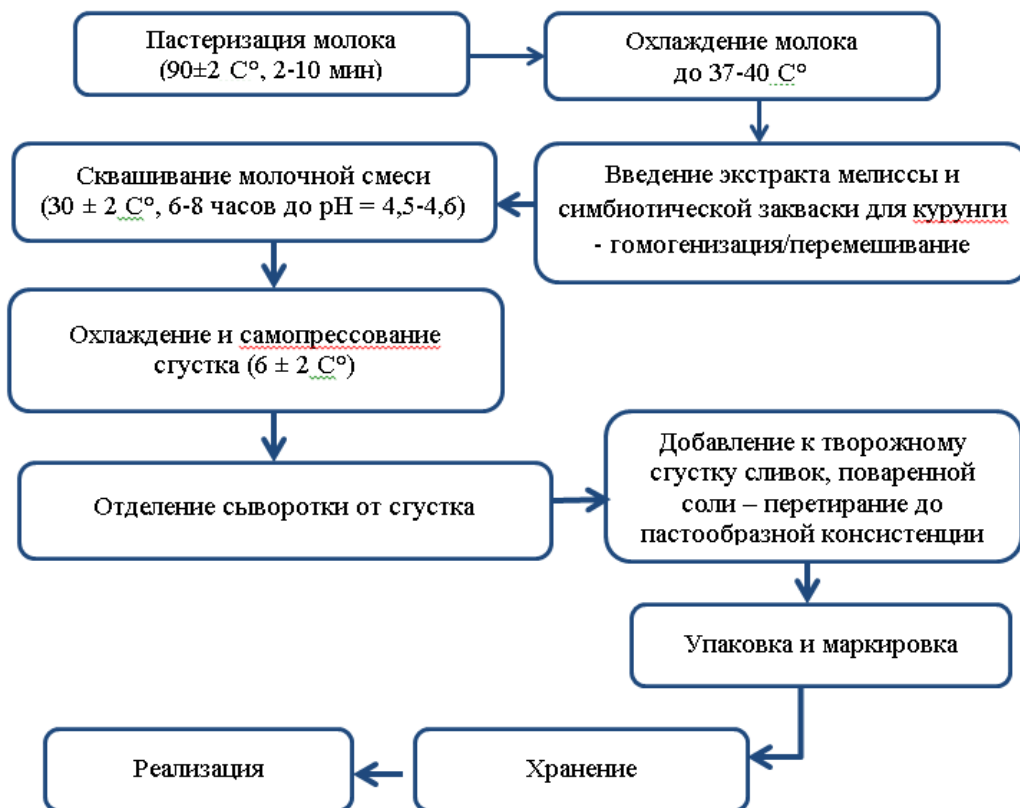
Рис. 4. Принципиальная схема производства творожной пасты с добавками Melissa лекарственной
