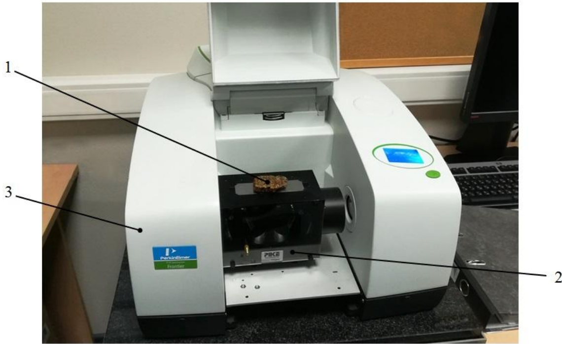
Рис. 2. Общий вид установки для определения оптических свойств перговых сотов: 1 – образец; 2 – кювета; 3 – ИК-Фурье спектрометр
