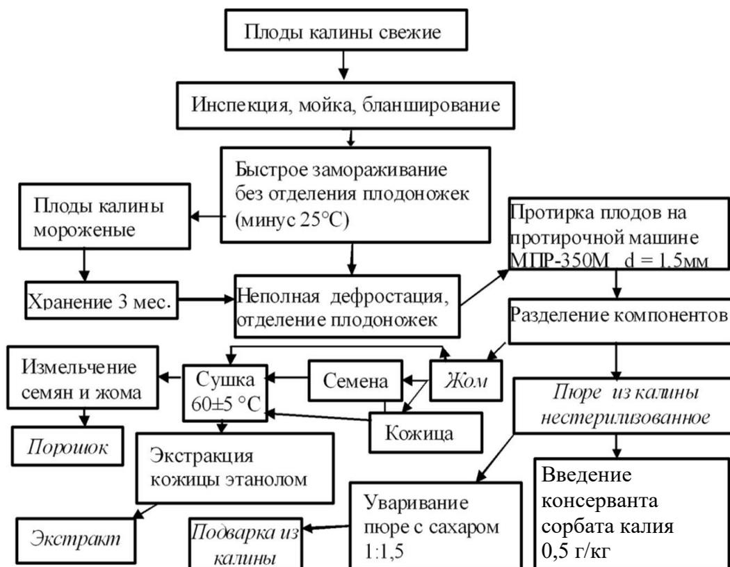
Рис.1. Технологическая схема производства продуктов переработки калины обыкновенной
