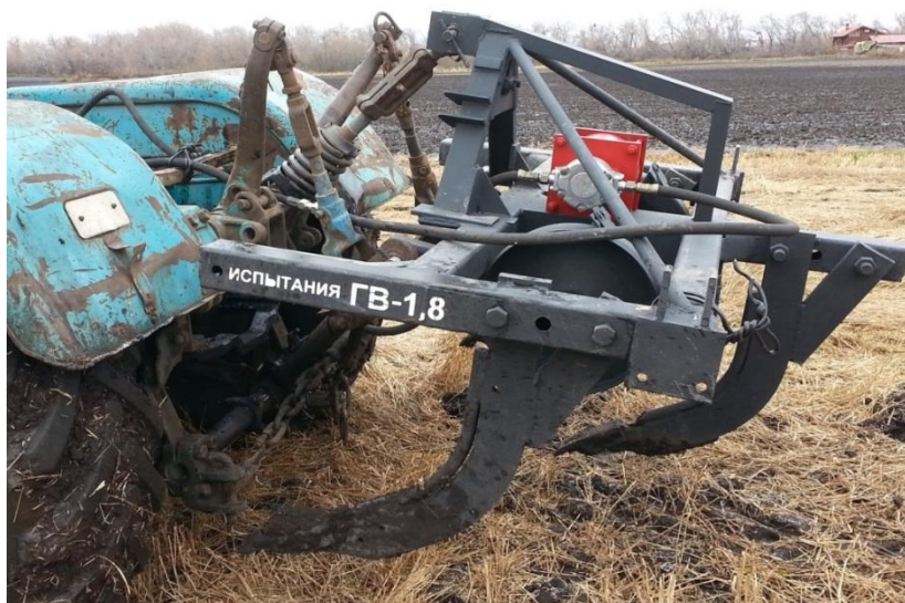
Рис. 1. Вибрационный глубокорыхлитель ГВ-1,8
