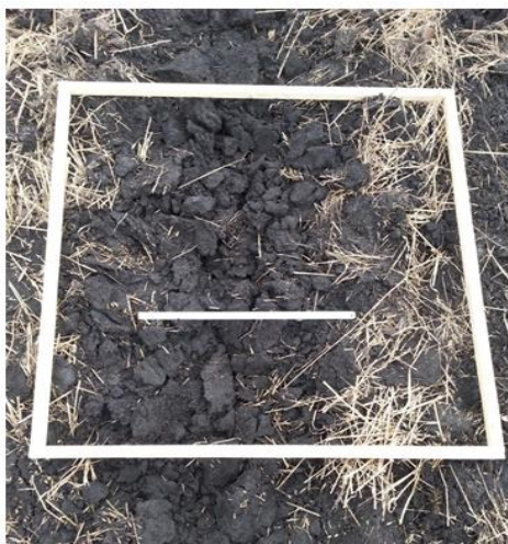
Рис. 3. Поверхность поля после прохода ГВ-1,8 на скорости 2,5 м/с без вибрации
