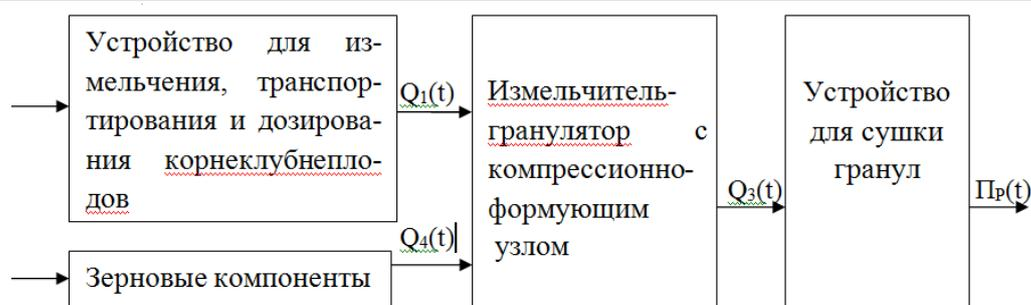
Рис. 1. Структурная схема линии приготовления гранулированных корнеклубнеплодно-зерновых продуктов:  $Q_1(t)$ ,  $Q_2(t)$ ,  $Q_3(t)$ ,  $Q_4(t)$  – подача исходного сырья и продуктов на соответствующих этапах их трансформации;  $Pr(t)$  – прочность готовых гранул
