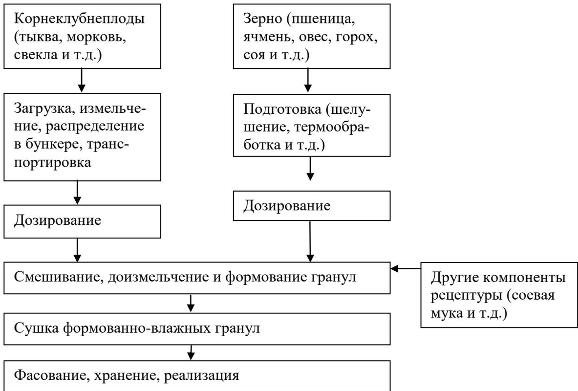
Рис. 4. Принципиальная технологическая схема приготовления гранулята на основе корнеклубнеплодно-зерновых композиций
