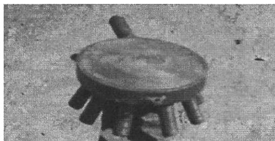
Рис. 5. Устройство для распределения потока рабочих жидкостей бактериальных препаратов – девятиканальная делительная головка
