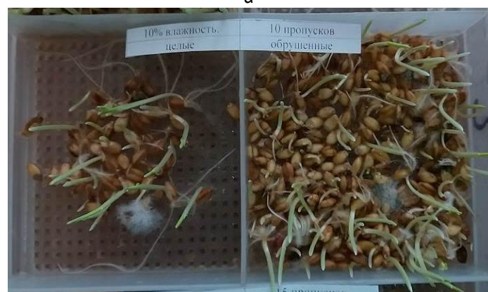
Рис. 2. Зерна влажностью 10 % до (а) и после (б) проращивания причисле пропусков через машину 10
