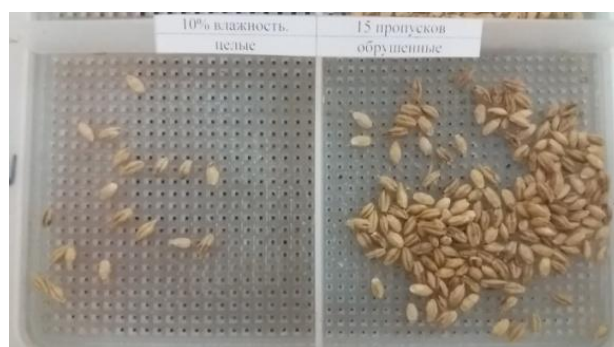
Рис. 2. Зерна влажностью 10 % до (а) и после (б) проращивания причисле пропусков через машину 10
