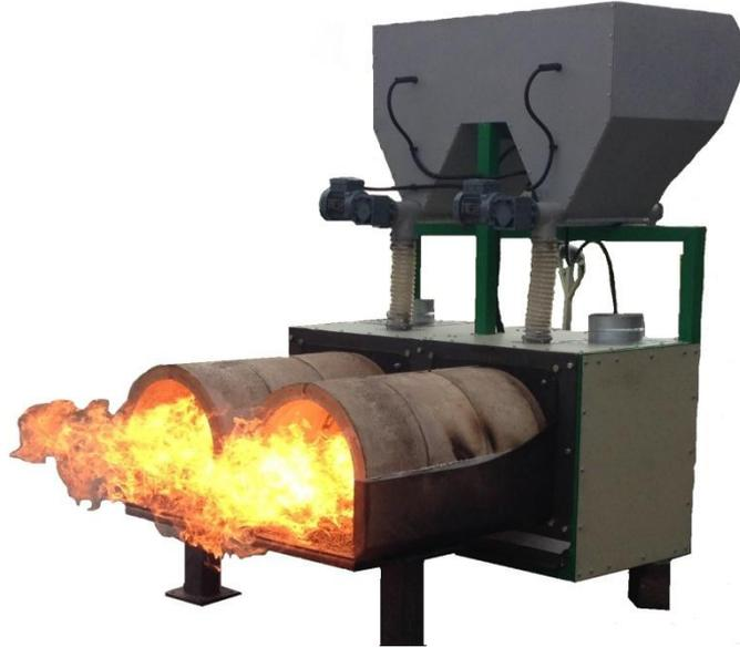
Рис. 3. Пеллетная горелка для зерносушилки [7]
