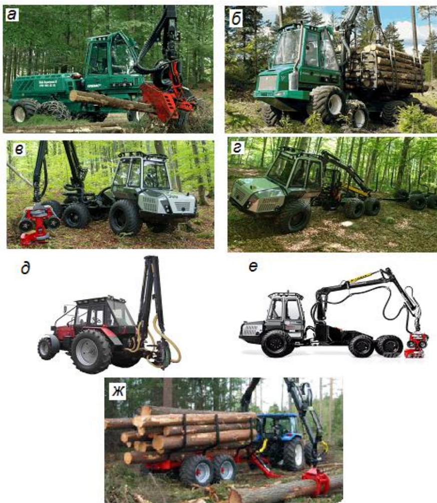
Рис. 1. Лесосечные машины для выполнения постепенных выборочных рубок леса: а – ВСРМ1050Н компании Greta (масса машины 11200 кг, диаметр спиливаемого дерева до 48 см); б – КСП 1050F компании Greta (масса машины 10700 кг, грузоподъемность 10000 кг); в – ВСРМ560Н компании Malwa (масса машины 5400 кг, диаметр спиливаемого дерева до 42 см); г – КСП 560F компании Malwa (масса машины 4700 кг, грузоподъемность с прицепом 9000 кг); д – ВСРМ МЛХ-1221 компании ОАО «Мозырский машиностроительный завод» (масса машины 5600 кг, диаметр спиливаемого дерева до 38 см); е – комбайн ВСРМ560С компании Malwa (масса машины 5400 кг, диаметр спиливаемого дерева до 42 см, грузоподъемность 6000 кг); ж – КСПМПТ-471 компании ОАО «Мозырский машиностроительный завод» (масса машины 12100 кг, грузоподъемность 10000 кг)
